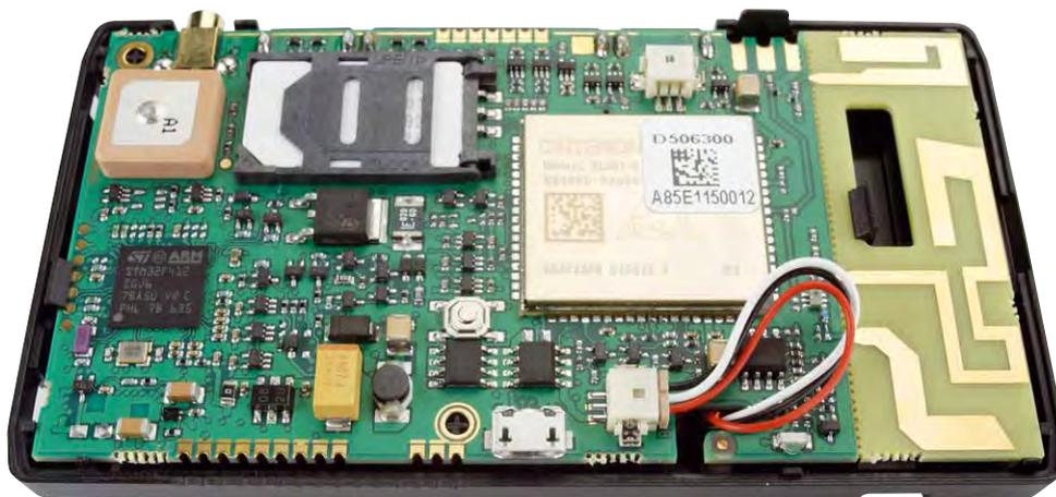
Im Inneren der Box wird die SIM-Karte eingesetzt
